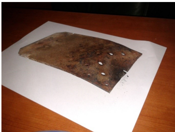
Foto 1 Deformeerunud põlemisrest ja läbipõlenud põlemiskamber
